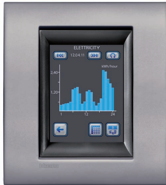
ÉCRAN TACTILE avec affichage de la consommation d'énergie, Plaque LIVINGLIGHT AIR Nickel Mat
